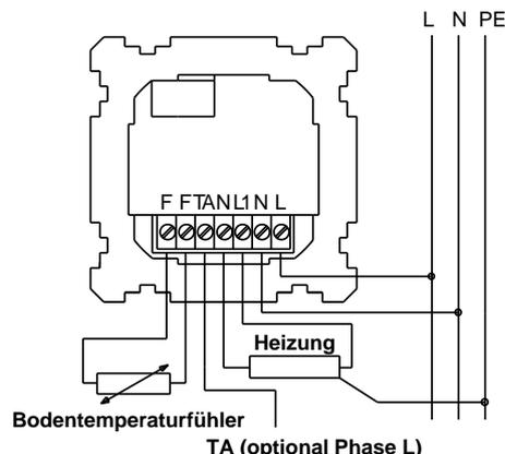
**Montage:** Der Temperaturregler wird in eine handelsübliche UP-Dose Ø 55 mm (nach DIN 49073, Teil 1) eingebaut. Beim Einsatz von zusätzlichen Zwischenklemmen empfehlen wir, eine tiefe Schalterdose zu verwenden. Der Anschluss erfolgt gemäß dem nebenstehenden Schaltplan. Die Anschlussleitungen müssen gerade und ca. 5 mm abisoliert sein. Montagehöhe ca. 1,5 m über dem Fußboden.
